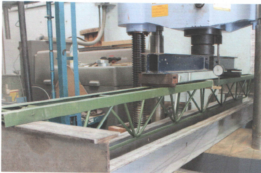
Figura 1-5 Montaje de la cercha – Cercha 2, L=3.0 m
